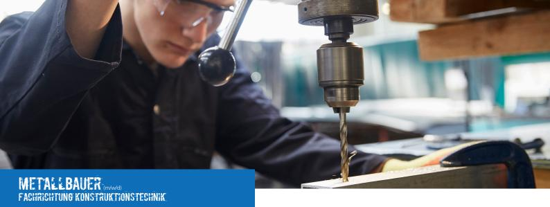
**Metallbauer (m/w/d)** der **Fachrichtung Konstruktionstechnik** stellen Stahl- und Metallbaukonstruktionen her und fertigen mithilfe manueller und maschineller Verfahren einzelne Bauteile aus Blechen, Profilen oder Rohren her und montieren diese auch.
