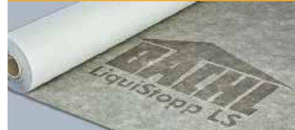
Die Trennlage BACHL Liqui-Stopp LS wird oberhalb der BACHL XPS® 300 C-SF Dämmstoffe, vollflächig verlegt. Die Verlegung der Trennlage muss mindestens 15 cm überlappend in Richtung der Dacheinläufe bzw. Gefällrichtung erfolgen. Bei Wandanschlüssen ist die Trennlage bis zur Oberkante der Kiesschicht hochzuführen.
